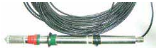
図4. 開発した単一調査孔を用いる地下水流向・流速計
